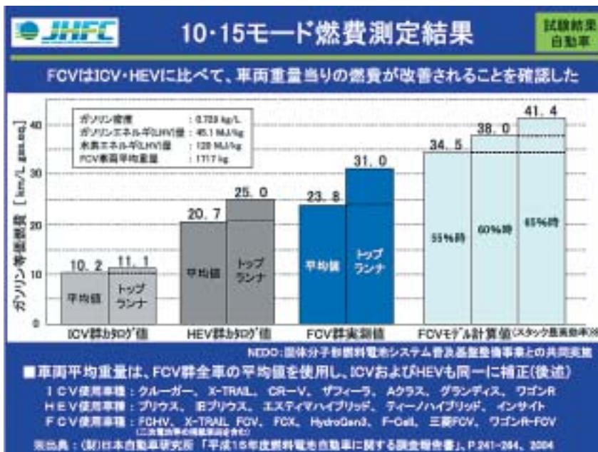
図2：ガソリン車、ハイブリッド車および水素燃料電池車の10・15モード燃費 出典 http://www.jhfc.jp/data/seminar_report/03/pdf/5_H16JHFC.pdf
