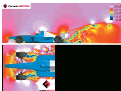
▲図2：フォーミュラカー周りの非定常流れの様子（流速の可視化）
