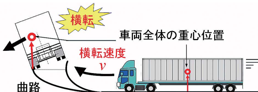
▲図1：コンテナトレーラートラック横転の原理
