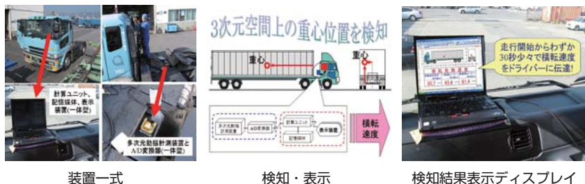
▲図3：3次元重心位置検知によるコンテナトレーラートラックの横転防止技術
