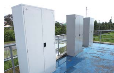
実験に使用した物置 (左より：ガイナ塗装・未塗装・断熱材施工)
