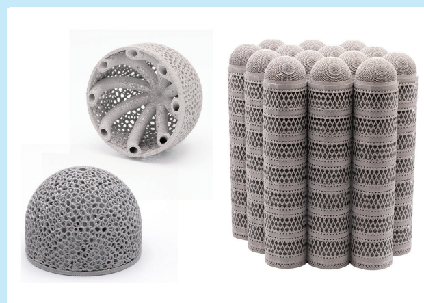
日本電子製電子ビーム金属3Dプリンターによる造形品
